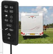
Las funciones Ferry, Off Road y Parking le permiten ajustar temporalmente la altura a una velocidad máxima de 30 kilómetros por hora. Las otras funciones solo pueden utilizarse con el vehículo parado.
