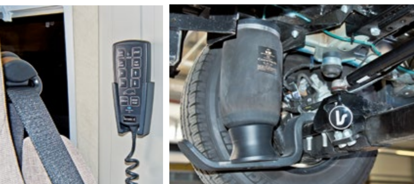
Rechts: Schön zu sehen der große Luftball, der die komplette Hinterachse trägt. Das Bedienteil erlaubt manuelle Einstellungen, beispielsweise Auto-Level oder Fahrwerksoptionen (Sport/Komfort).
